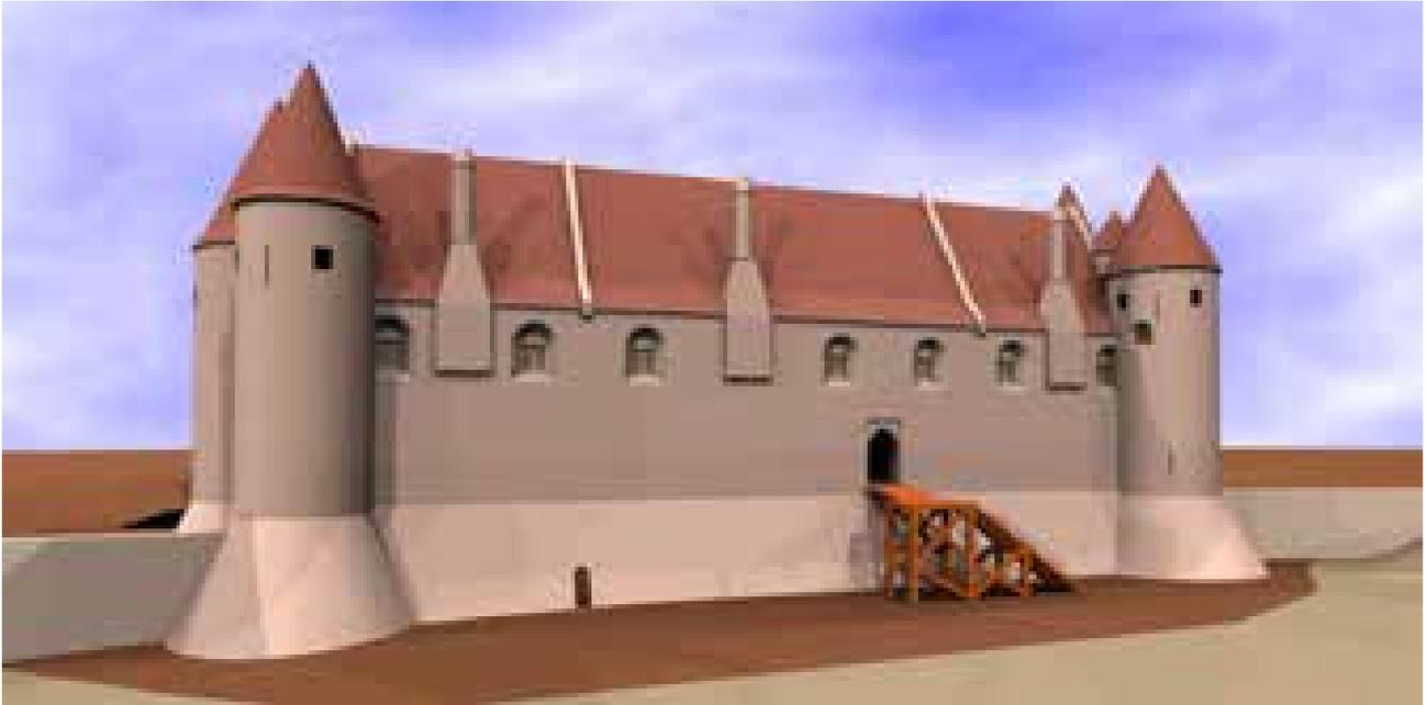
*Fig.13: Vue rapprochée du château-palais de Manassès, prise depuis le nord. La rampe d'accès en bois et la porte d'entrée haute sont de simples spéculations. La poterne basse est probable en raison de la présence de l'escalier visible dans les caves (dessin J.Mesqui 2013)*
